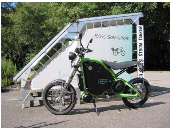
vier PV-Module direkt integriert als Dach für die Ladestation
